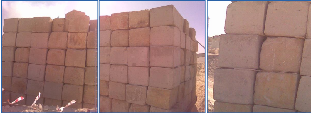
الشكل (4-33) المكعبات البيتونية مع الحشرات الخشبية بين المكعبات
