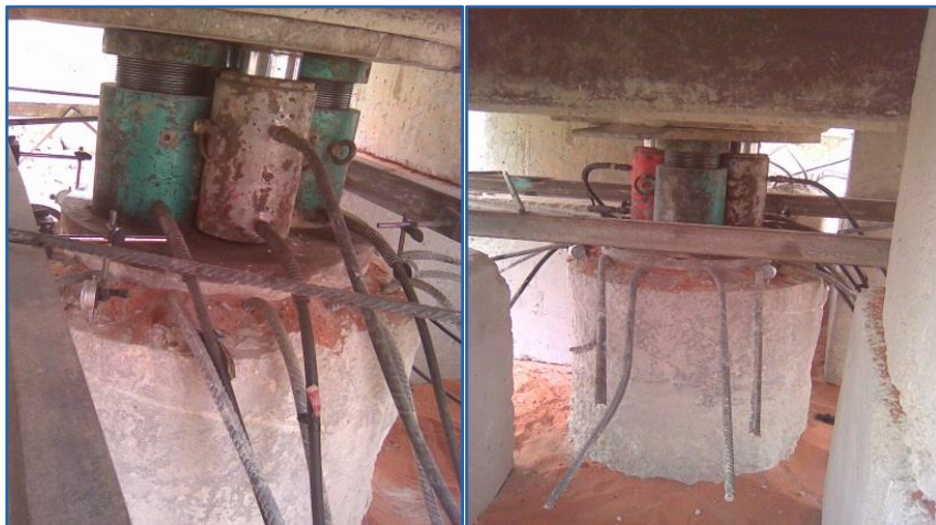
الشكل (4-38): تجربة عامل وتد قطر 90 سم
