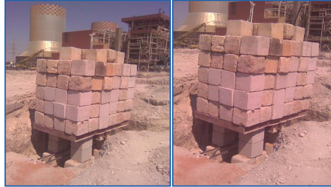
الشكل (32-4): صورة لتجربة تحميل حقلية على الضغط
