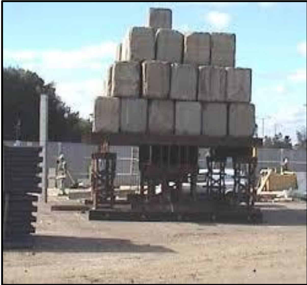
الشكل (2-7): تجربة تحميل حقلية على الضغط منفذة بواسطة (مكعبات بيتونية)
