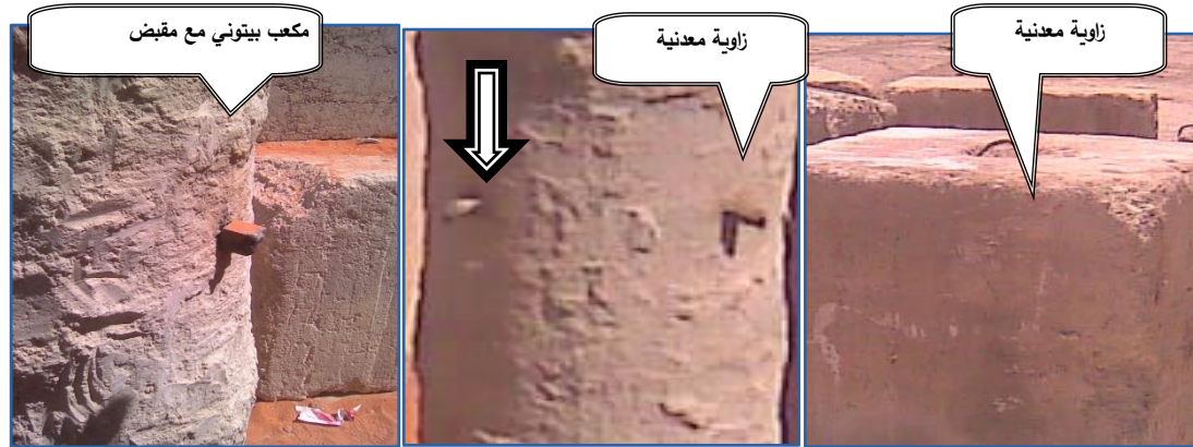
الشكل (4-5): تثبيت الزوايا في وتد الاختبار
