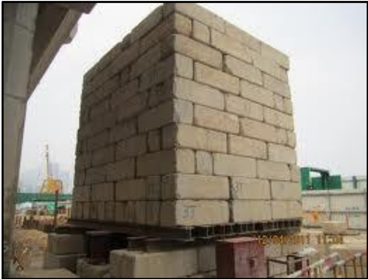
الشكل (2-6): رسم بياني تخطيطي لتنظيم تجربة تحمل الوتد في الحقل
