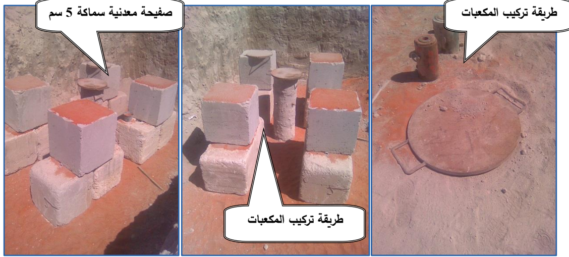
الشكل (4-4): تركيب المكعبات
