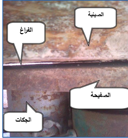
الشكل (31-4) الفراغ بين الصفحة العلوية والطاولة الحاملة للمكعبات
