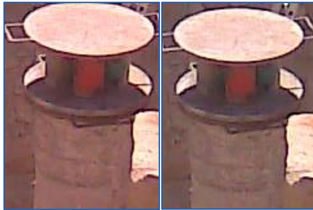
الشكل (4-30): تركيب الصفائح والمكابس الهيدروليكية على رأس الوتد
