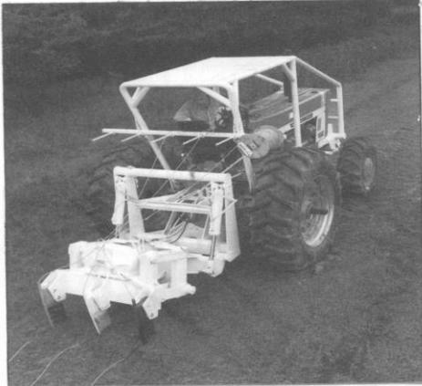
الشكل ( 6 - 8 ) طمر حبل التفجير في التربة بواسطة المحراث الهزاز
