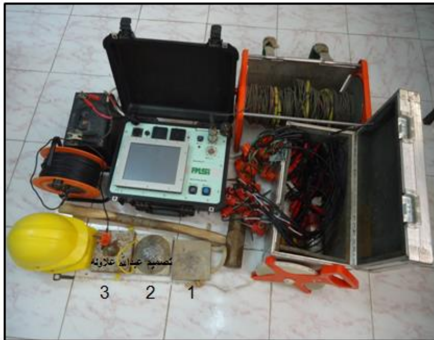
الشكل (٢٦) الادوات المستخدمة في الأعمال الحقلية وجمع البيانات السيزمية.
