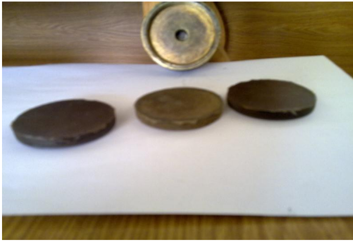
الشكل (3): قالب تشكيل عينات اختبار قساوة المطاط و3 عينات.
