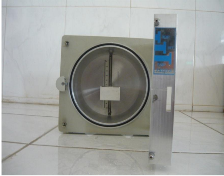
الشكل (4) خلية (كانبيرا) ذات تدريجات من 0 حتى 5 cm لتحديد مسافة التشعيع.
