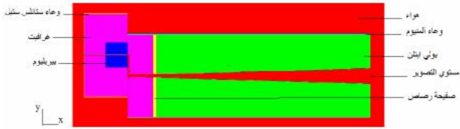
الشكل (11) مقطع أفقي في المستوى x-y لمنظومة التصوير بالنترونات الحرارية في المسرع السوري باستخدام الكود MCNP5-BETA.
