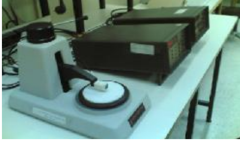
الشكل (5) جهاز قياس المقاومة النوعية بطريقة المسابر الأربعة
