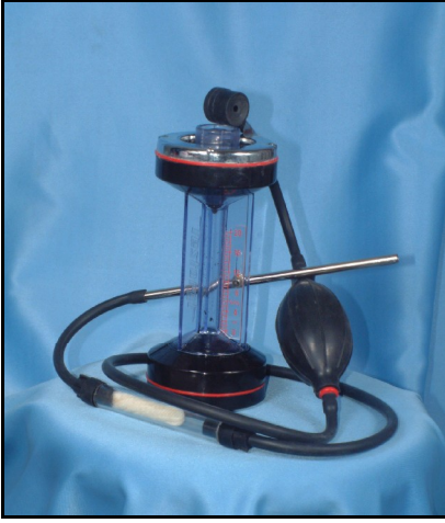
الصورة (2) توضح جهاز قياس نسبة غاز ثاني أكسيد الكربون
