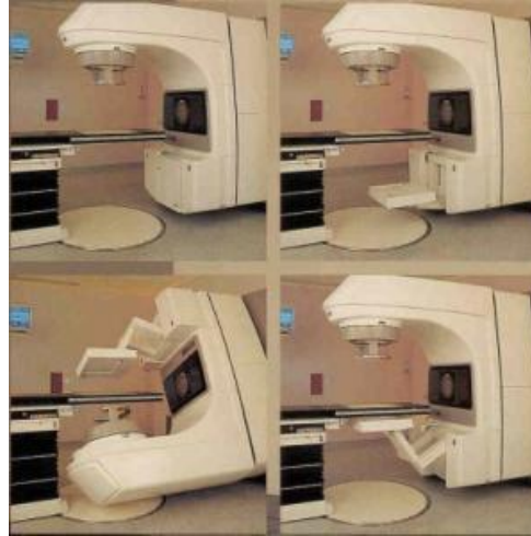
شكل(6) يوضح هذا الشكل وضع جهاز ال Portal Image مع جهاز المسرع الإلكتروني
