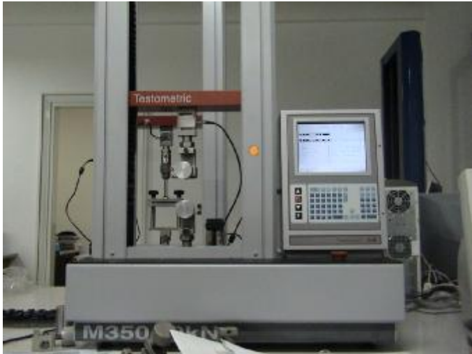
الشكل رقم(3): جهاز الاختبارات الميكانيكية نوع (Testometric) من شركة (Testometric Co.Ltd) (مركز الاختبارات الصناعية).
