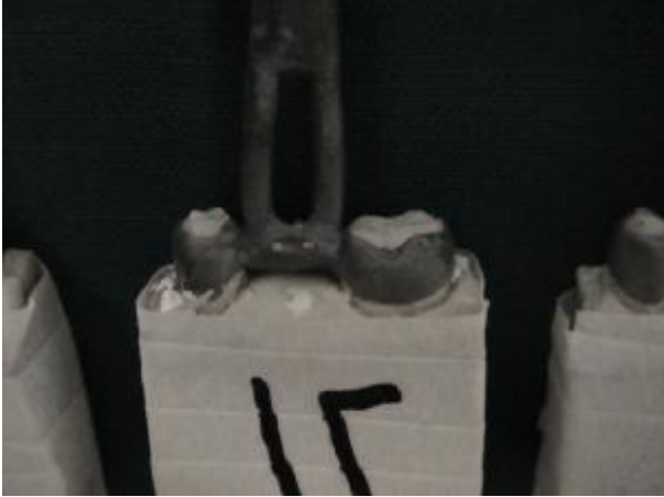
الشكل رقم (1): يبين جسر الأطواق على المثال الأكريلي مع عروة تطبيق قوى الشد (جامعة دمشق - مركز الاختبارات الصناعية)
