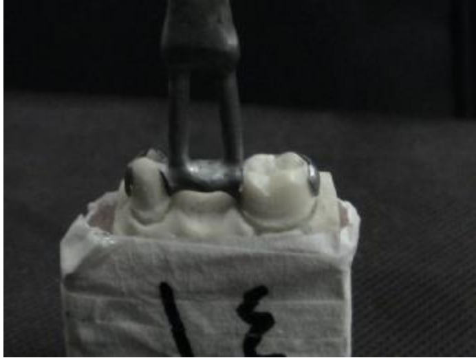
الشكل رقم(2): يبين جسر ثلاثة أرباع الطوق على المثال الأكريلي مع عروة تطبيق قوى الشد (جامعة دمشق - مركز الاختبارات الصناعية)
