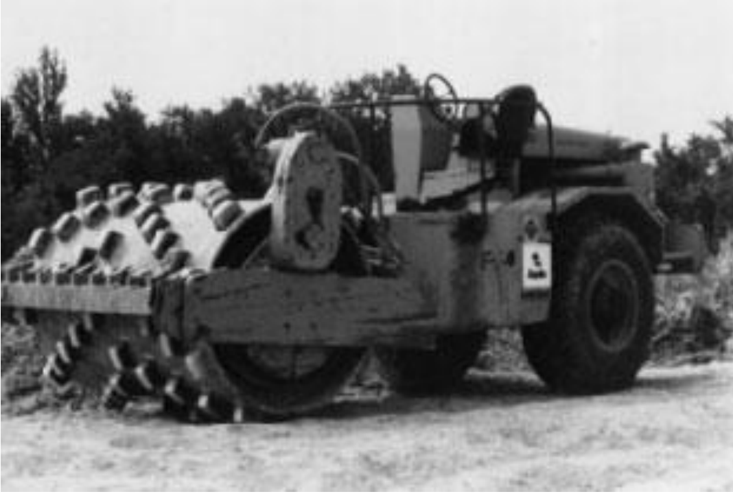
الشكل (17.6) : مداخل أرجل الغنم
