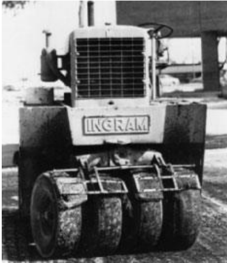
الشكل (16.6) : مداخل دواليب المطاط الهوائية
