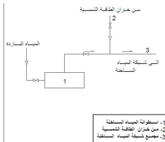
الشكل رقم ١ الوصل المباشر مع شبكة المياه الساخنة
