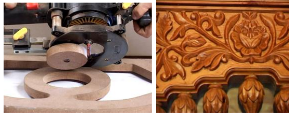
الشكل (41) حليات زخرفية على الخشب نُفِّدَتْ بالراوتر الذي يساعد في قطع الحليات الزخرفية
