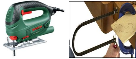
الشكل (39) المنشار السلكي الأركت fretsaw لقطع الحليات الزخرفية و منشار المنحنيات jigsaw
