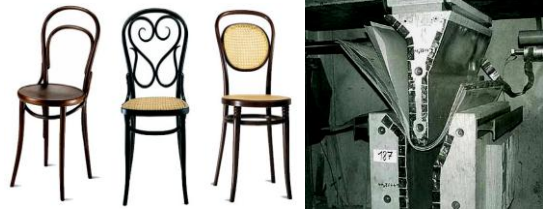
الشكل (34) آلة تشكيل الرقائق الخشبية بالثني الحراري ونماذج كراسي تونيت الخشبية المشكلة بالثني الحراري بالبخار
