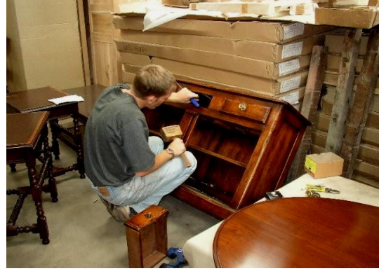
الشكل (8) تنفيذ أعمال نجارة الخزائن الخشبية
