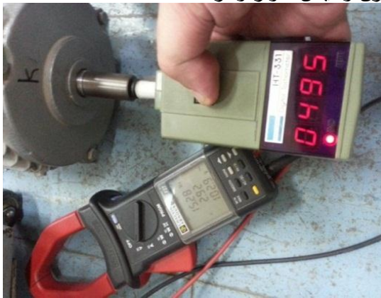
الشكل (42) تشغيل محرك أحادي الطور على التردد 50/3Hz، والتوتر حوالي 100 فولت وسرعة الدوران 1/3 السرعة الاسمية.
