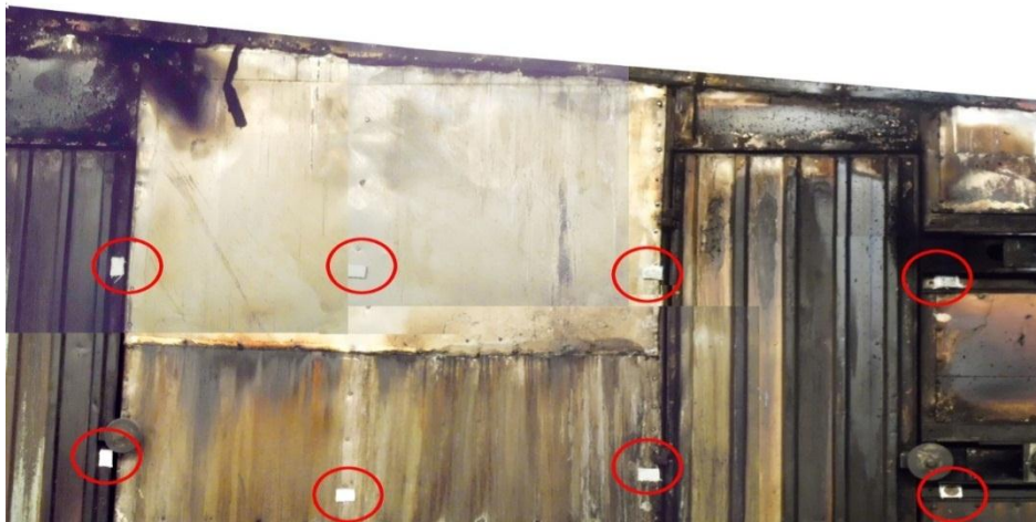
الشكل (5) جزء من جدار الفرن يبين نقاط شبكة تقسيم جدار الفرن
