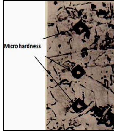
الشكل (3) البنية المجهرية لفولاذ التجربة المعرض للتقسية والإرجاع فقط دون عملية النتردة مع إظهار القساوة الميكروية X400.
