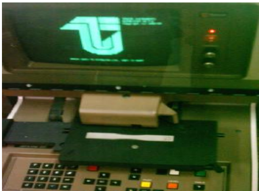
الشكل (7) جهاز قياس الخشونة (a-step) المستخدم (المعهد العالي للعلوم التطبيقية والتكنولوجيا)
