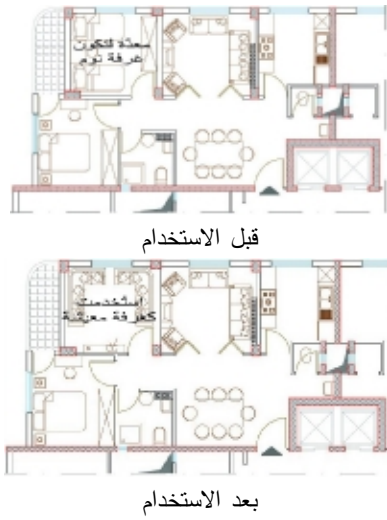
الشكل (12) مسكن ادخار محلي لأسرة شابة (شخصان) أعيد فيه استعمال فراغ مصمم كغرفة نوم للمعيشة، إعداد الباحث عن المؤسسة العامة للإسكان.
