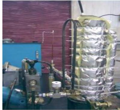
الشكل (8) يبين صورة عامة لمنصة قياس معامل بلك بمؤثري الضغط ودرجة الحرارة
