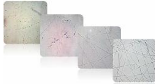
الشكل (3) صور مجهر ضوئي (70x70 μm) للألياف المتشكلة بتقنية ES.
