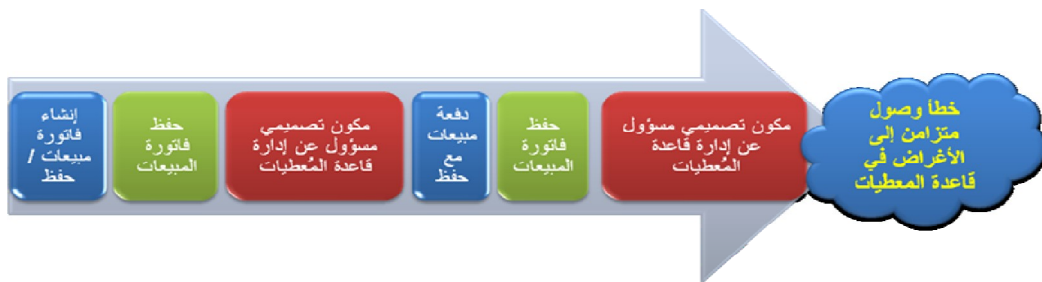
الشكل 11: مسار استدعاء مكونات النظام الذي أدى إلى وقوع خطأ
