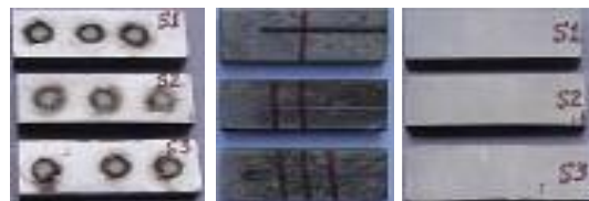
الشكل (2): العينات الفولاذية (من أنواع الفولاذ الثلاثة) كما استلمت، وتم صقل سطوحها بالجلخ الآلي والسماذج، ثم تحديد التركيب الكيميائي بطريقة التحليل الطيفي.
