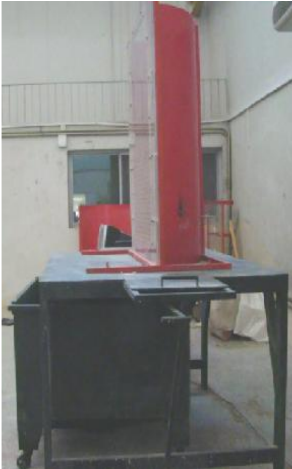
الشكل (3) نموذج الصومعة مع الجدار المنصف-ووعاء التفريغ والتعبئة
