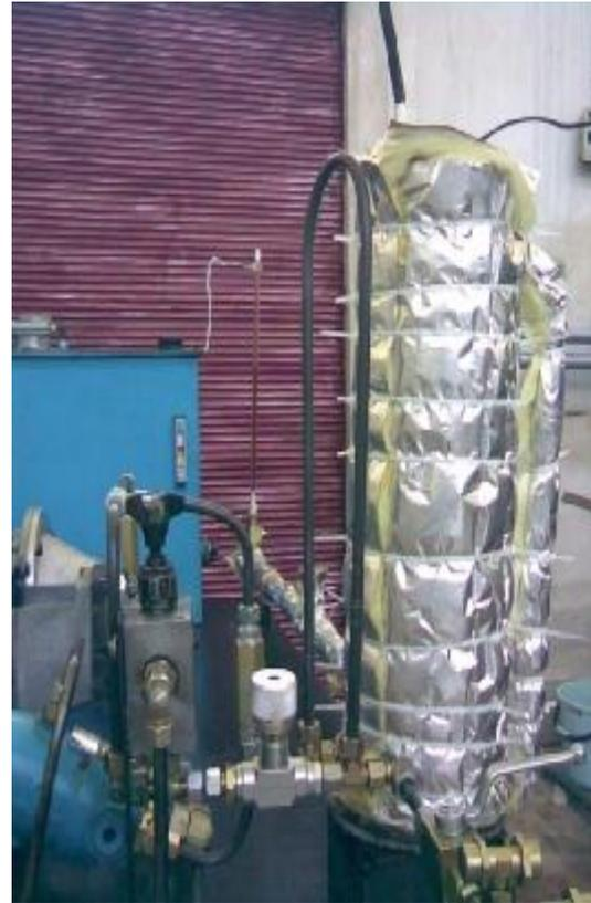
الشكل (2) صورة عامة لمنصة قياس معامل بلك بمؤثري الضغط ودرجة الحرارة
