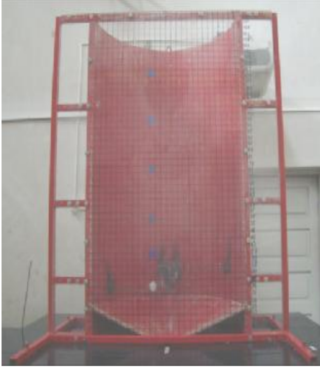
الشكل (1) نموذج الصومعة المستعمل في التجارب
