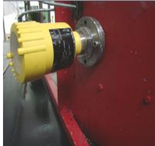
الشكل (3) تثبيت خلية قياس الضغط على النموذج
