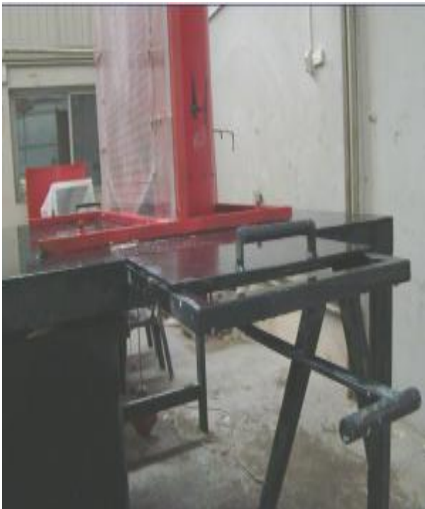
الشكل (6) ذراع التحكم بفتح وإغلاقها فتحة المخرج
