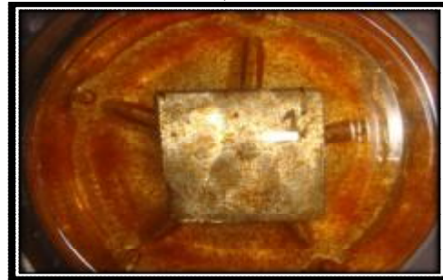
الشكل (10-1) العينة رقم (1) بعد التعرض لوسط التآكل NaCl,H 2 O 2
