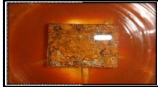
الشكل (9-1) العينة رقم (3) بعد التعرض لوسط التآكل NaCl,H 2 O 2
