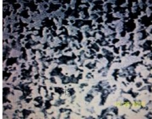
فولاذ كربوني نسبة الكربون فيه 0.314%
