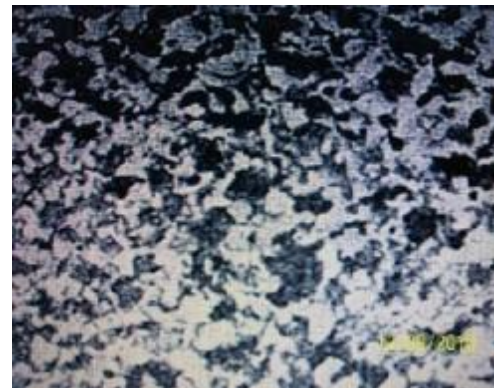
فولاذ كربوني نسبة الكربون فيه 0.496%
