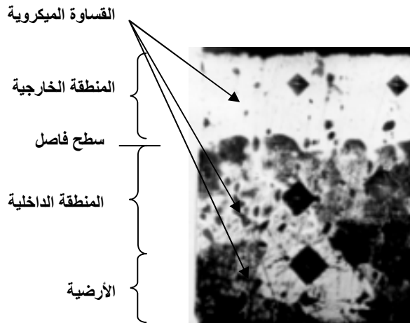
الشكل (5): البنية المجهرية والقساوة الميكروية لطبقة الألمنة عند (950^\circ C, 4 h) ، X400
