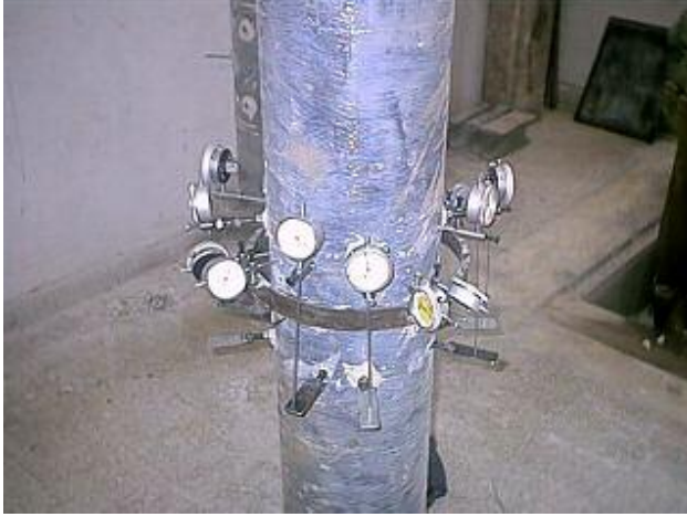
الشكل (10). أجهزة قياس التشوهات الطولية و العرضية.
