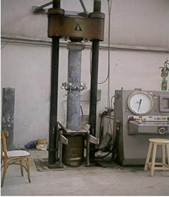
الشكل (9) العمود المدعم و طريقة وضع أجهزة قياس التشوهات في أثناء الاختبار
