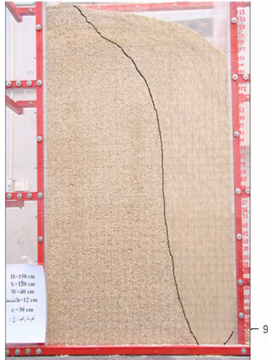
الشكل (2-5) تغير شكل الجريان موقع فتحة التفريغ يبعد 30 سم عن المركز
