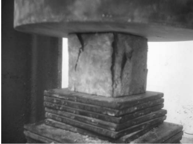
الصورة (6) : عينة مغلفة بالإيبوكسي في مرحلة الكسر (حمض الكبريت).
