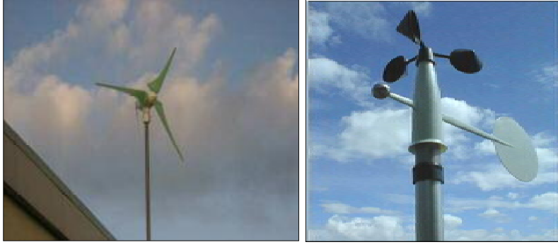
الشكل (2.6) عنفة ريحية استطاعة 1Kw.
