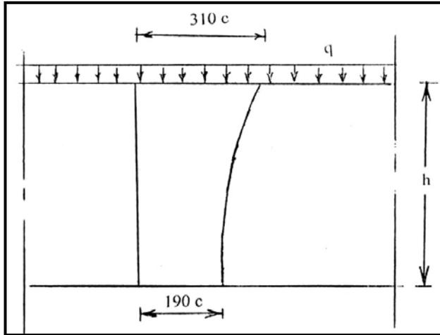
الشكل رقم 8. توزيع درجة الحرارة بعد مضي 5 sec لبلاطة معزولة  $m=0$
